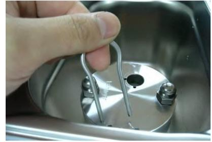
③ バルブヘッドのロックングデバイスを抜きます。
