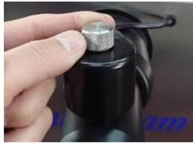
② 電磁弁上部のネジを外し、マグネットバルブも一緒に外します。
