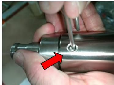
⑤ ロッキングデバイスを使い、ホイッピングパイプのロックングボルト(バネ式)を押し込み、ホイッピングパイプを回しながら両端部(2ヶ所)を外します。
